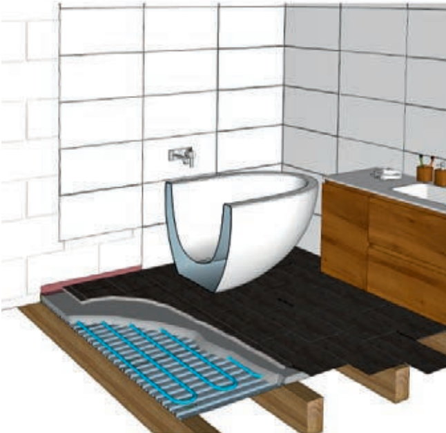
Badezimmerboden mit wasserbeständigem Randanschluss am bestehenden Mauerwerk
